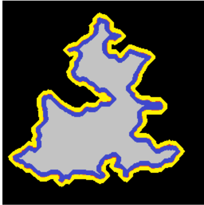
Figura 2.1: Erosión y dilatación binarias: dilatación (amarillo), erosión (azul) e imagen original (gris).
