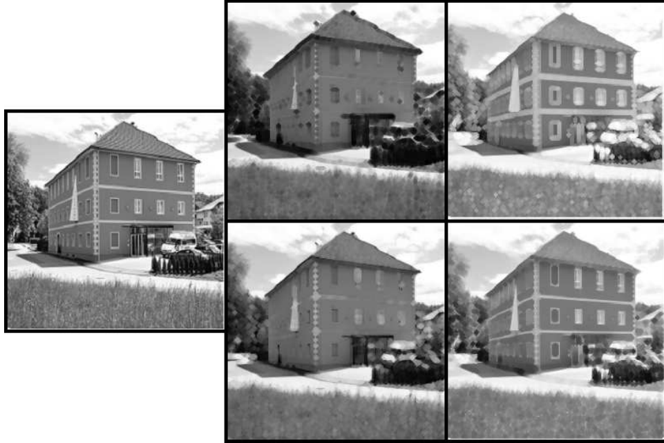
Figura 2.3: Operaciones morfológicas en escala de grises: 1era columna, imagen original; 2da columna, erosión y abertura; 3era columna, dilatación y cerradura.
