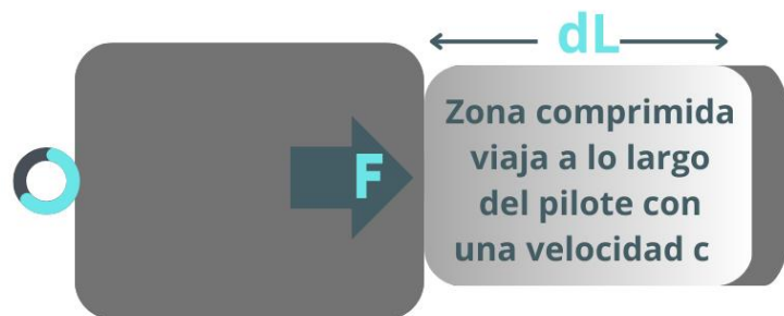
Figura 3. Propagación de la onda a través de una pila o pilote (Modificado de Beim J, 2020)
