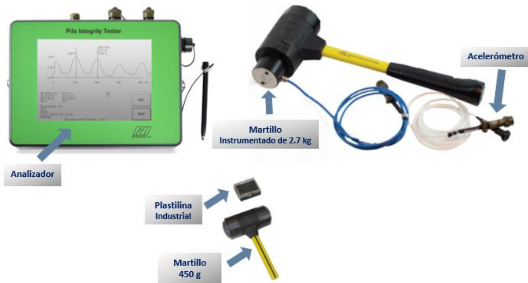
Figura 6. Equipo e instrumentación para la ejecución de la Prueba de Integridad (PIT)
