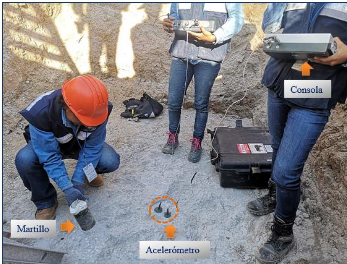
Figura 9. Equipo empleado y ejecución del ensayo (SDS, 2020)
