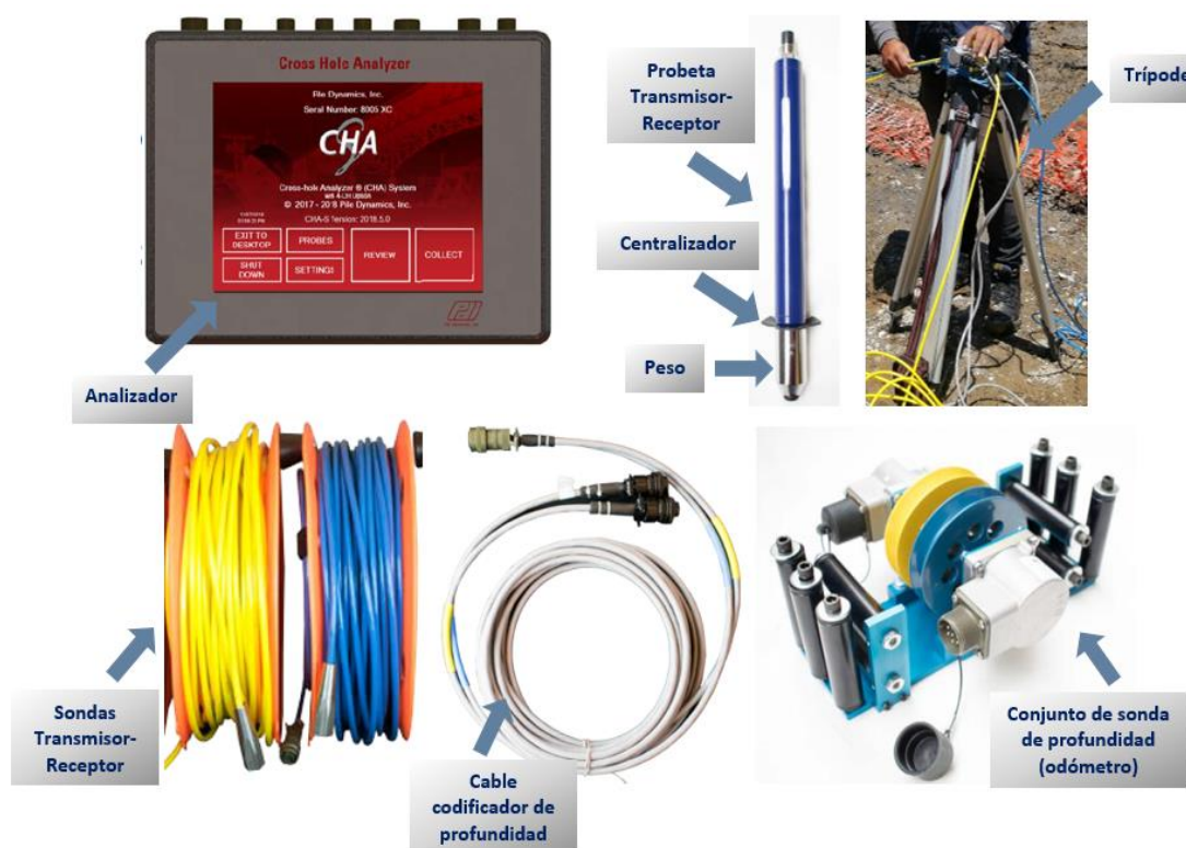
Figura 24. Equipo e instrumentación para la prueba de Cross Hole Ultrasónico (CSL)
