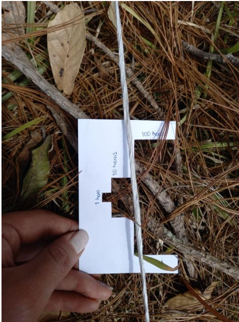
Figura 10. (Izquierda) Conteo de combustibles con calibrador de combustibles.
