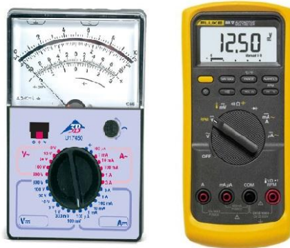
Figura 4 Multímetro analógico (izquierda) y multímetro digital (derecha)
