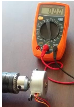
Figura 16 Medición del voltaje de salida del motor a pasos.
