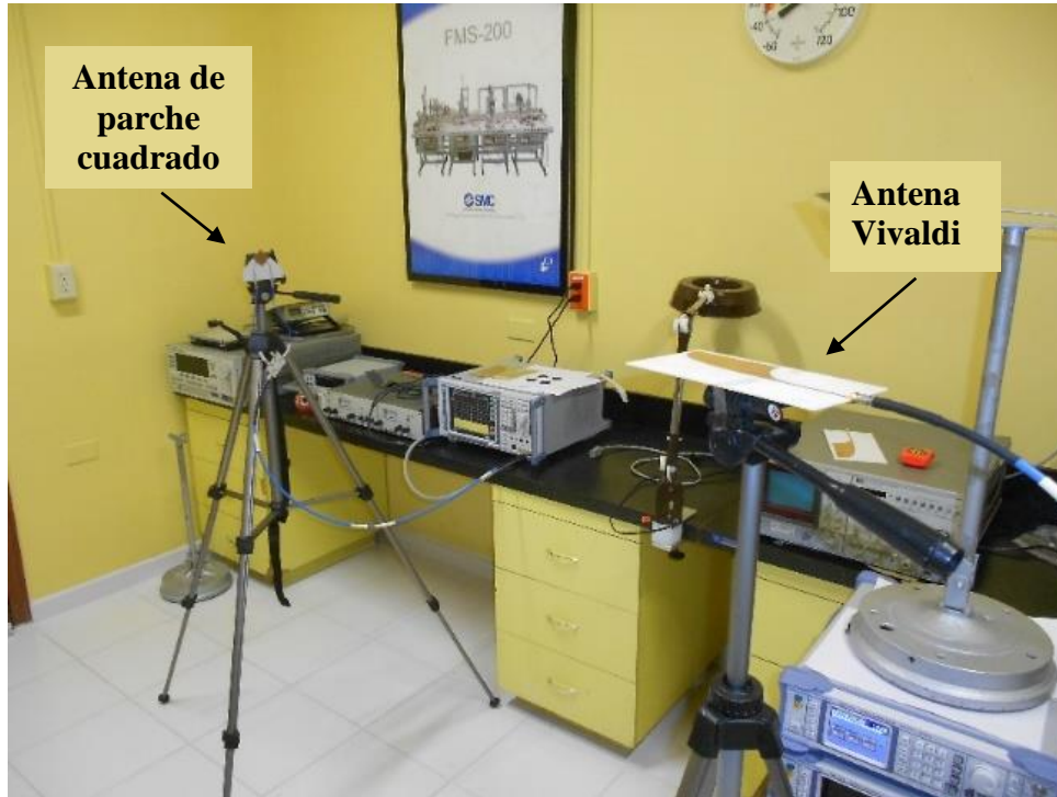
Figura 4.21. Montaje para la medición de la ganancia.
