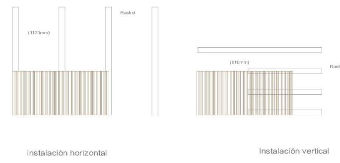
DETALLE-02 REVESTIMIENTO DE MADERA EN FACHADAS SUROESTE-NOROESTE
