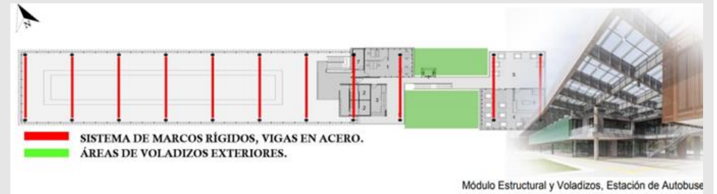
CUBIERTA DE LA ESTACIÓN DE AUTOBUSES LÜLEBURGAZ
