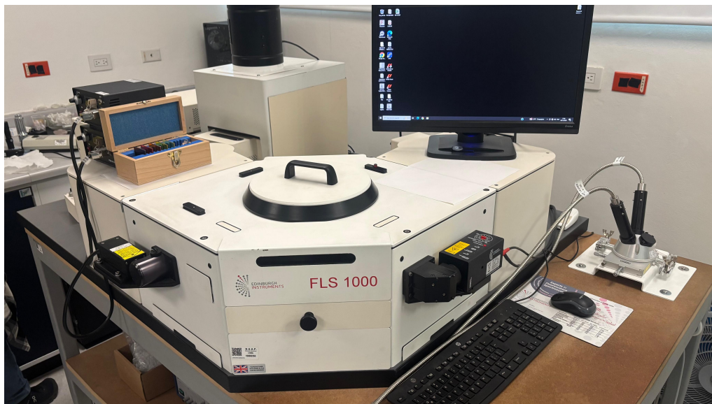
Figura 2.5: Equipo de medición fotoluminiscencia del laboratorio área de caracterización en la FCFM-BUAP.
