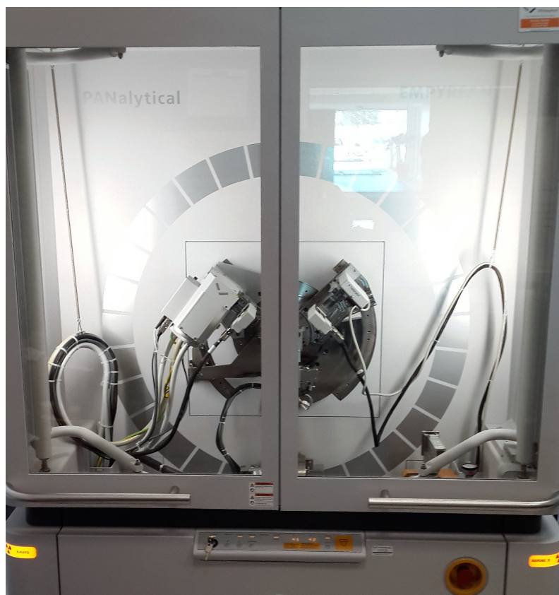
Figura 2.2: Equipo de medición de rayos X del CINVESTAV.
