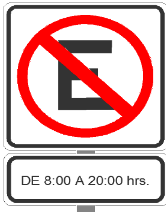
Figura IV.28.- Señal restrictiva (SR-22), que prohíbe estacionarse.
