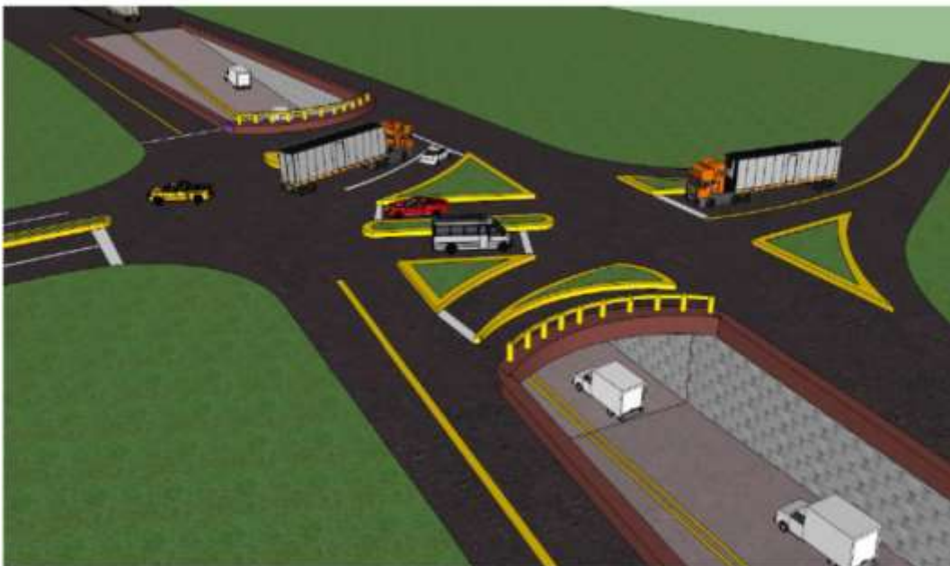
Figura V.25.- Propuesta de paso a desnivel subterráneo acceso 1.
