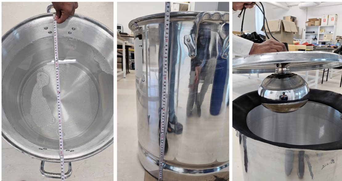
Figura 6.1: Ensamble del detector con el PMT acoplado y el líquido centellador colocado.
