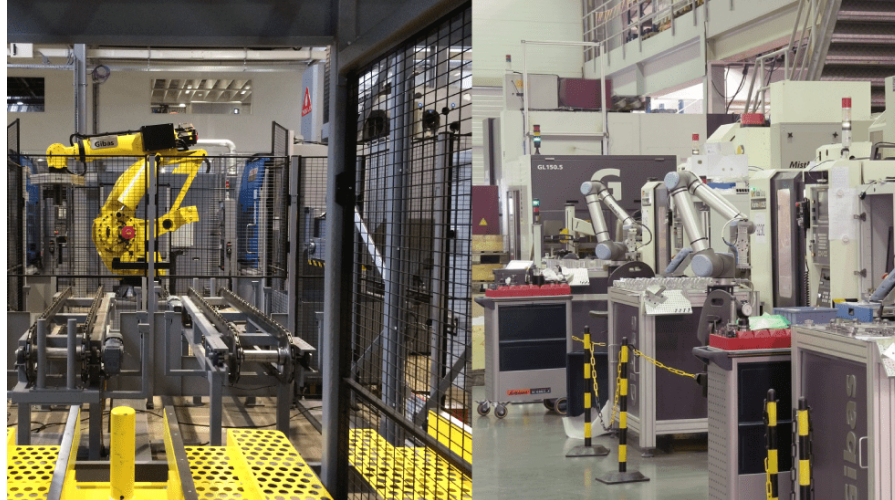
Figura 1.1: Comparación de robots industriales y cobots obtenido de ”https://gibas.nl/en/gibas-automation/production-automation/robot-and-cobot/”
