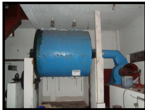
SECADORA 25 QUINTALES/HORA CON TOLVA METÁLICA EN SU PARTE SUPERIOR DE LA MISMA CAPACIDAD Y SOPORTADA EN SU PARTE INFERIOR SOBRE BASES DE CONCRETO ARMADO
