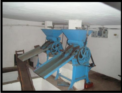
AREA DE DESPULPadora CON PENDIENTE PARA LLENAR LOS TANQUES DE FERMENTACION
