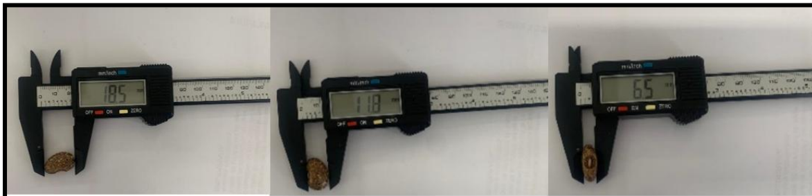
Figura 7. Largo, ancho y grosor del grano determinados con un vernier digital.
