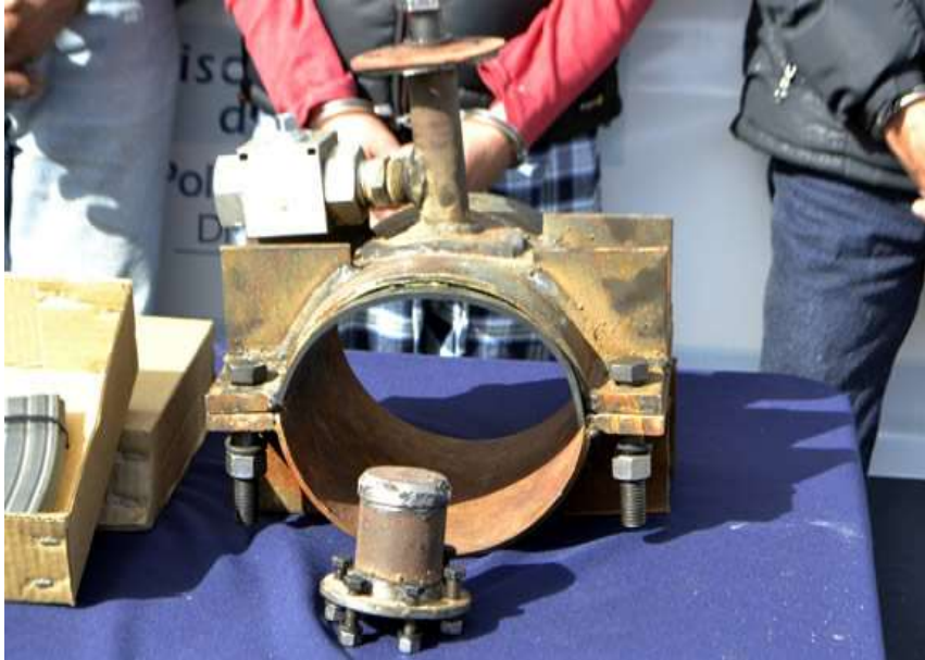
Figura 4.11.- Los dispositivos caseros utilizados en la ordeña de los oleoductos o en la ramificación de los caudales en la distribución del agua potable, debilitan la condición de estabilidad estructural de cualquier sistema hidráulico.
