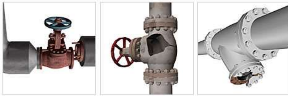
Figura 2.1.5.- Daño en tubería ocasionado por golpe de ariete.
