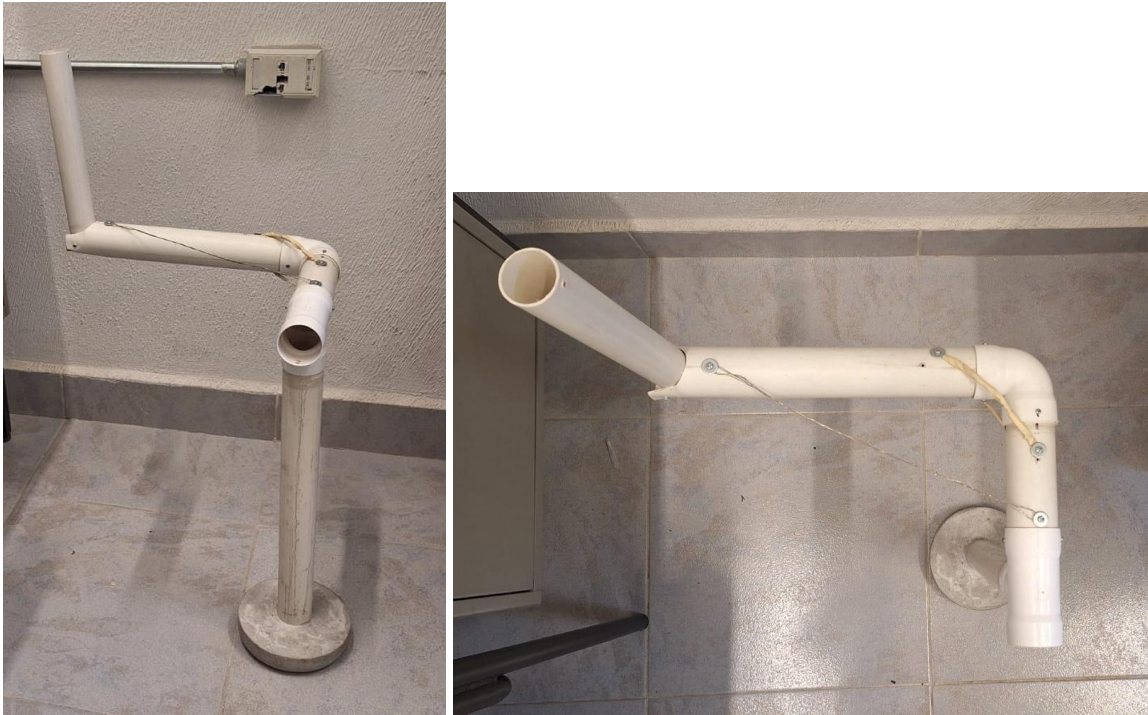
Figura 11. Prototipo de brazo humano, su realización fue hecha para las pruebas de control, antes de poderlas realizar en humanos, su construcción fue hecha con pedazos de tubo PVC, una base de cemento y un poco de alambre para mantener el tubo en un ángulo de 90° grados esto para asemejar la posición de un brazo extendido al frente
