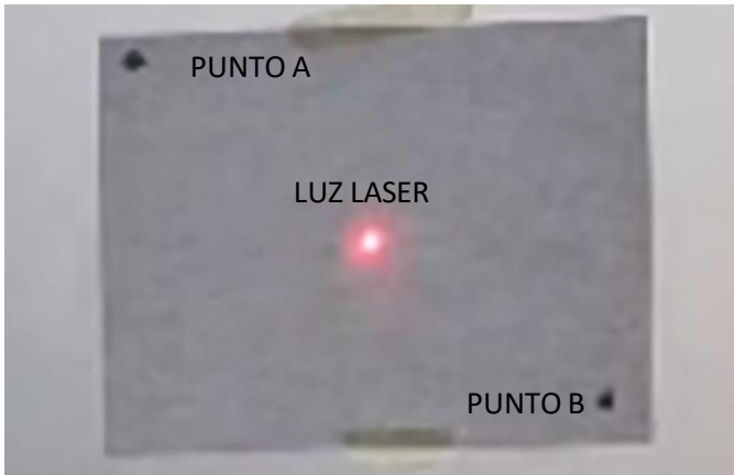
Figura 13. Hoja de marcaje (diana) es donde se emite la luz del láser y donde se centraba la grabación en video, con la finalidad de tener un recorrido completo en imagen desde el punto A al punto B
