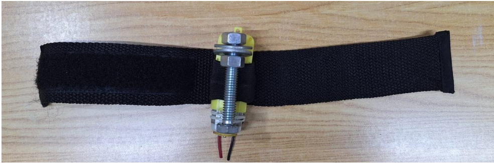
Figura 12. Prototipo electromecánico con banda ajustable, se creó con tela de resorte que sostenía el mecanismo y tela velcro que cubriría la zona de la muñeca de los pacientes
