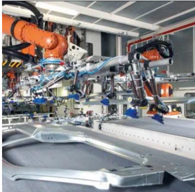
Ilustración 3 Imagen del EOL en donde el Robot de descarga deposita la pieza sobre la banda de salida
