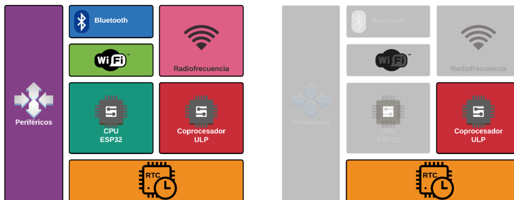
Figura 12-Arquitectura interna del ESP32 en modo activo (izquierda) y en modo Deep Sleep (derecha), tomado de [68]
