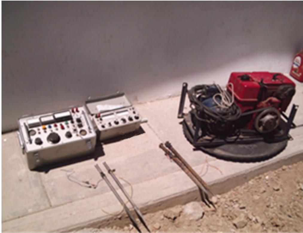
Figura 4.3. Equipo SCINTREX utilizado en la adquisición de los datos de resistividad aparente. De izquierda a derecha de la imagen se tiene el transmisor, el receptor y el motogenerador; así como los electrodos empleados.
