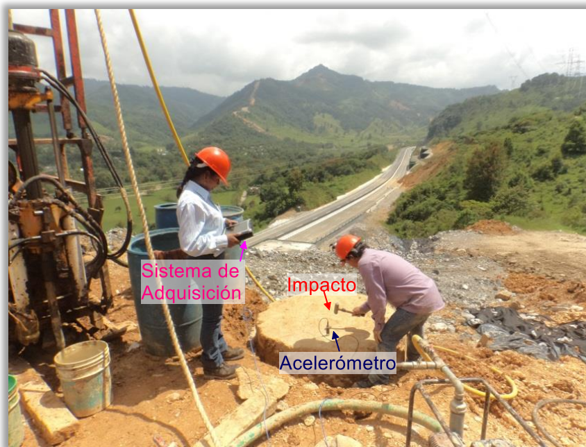
Figura 3.1 Distribución del acelerómetro e impacto para el ensayo PET (Pile Echo Test).
