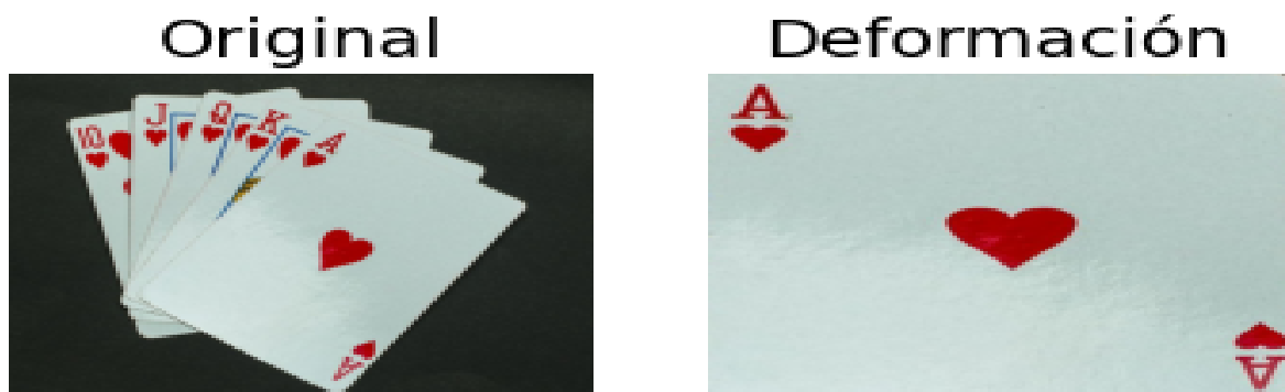
Figura 2.12: Ejemplo de aplicación de warping a una imagen. Como resultado el as obtiene una nueva perspectiva y tamaño.
