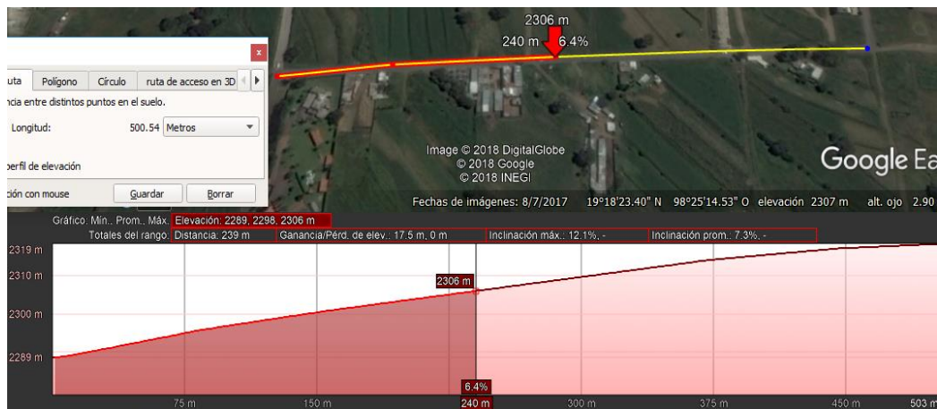
Imagen No. 88. Sección longitudinal y perfil topográfico de los últimos 500 metros de ruta.
