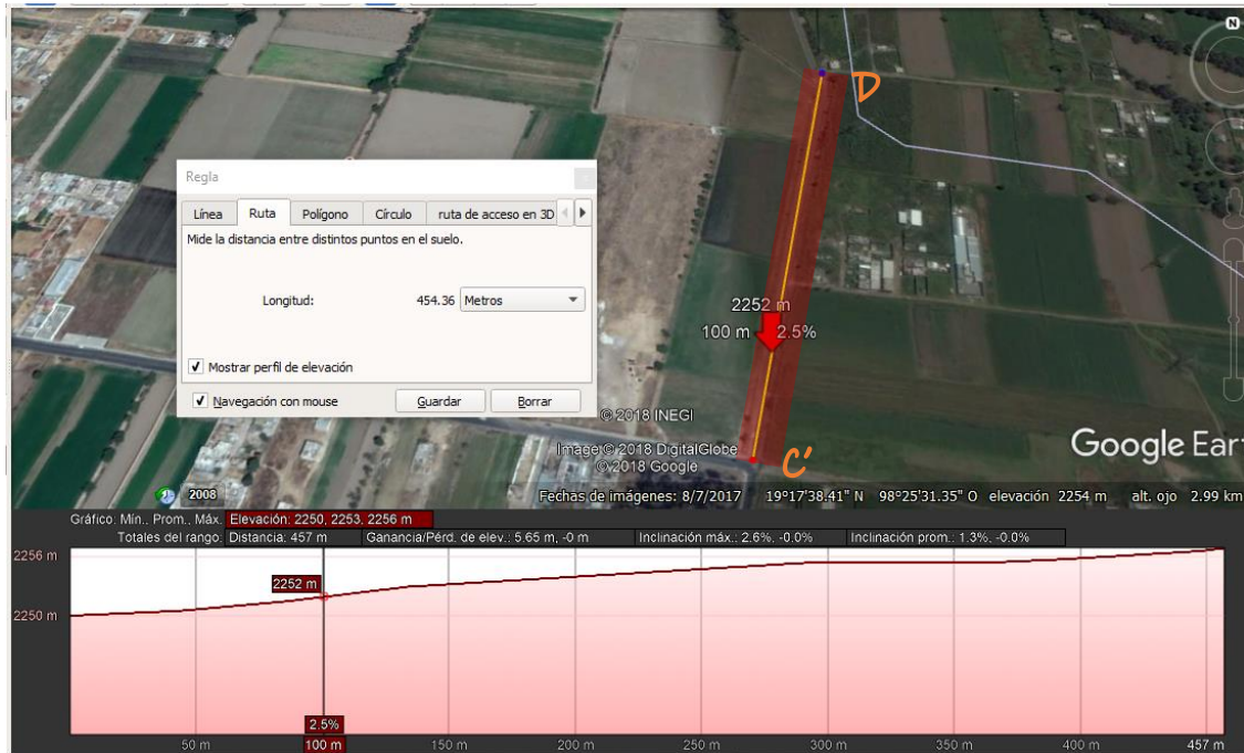
Imagen No. 23. Sección longitudinal y perfil topográfico C' – D (tramo 2).
