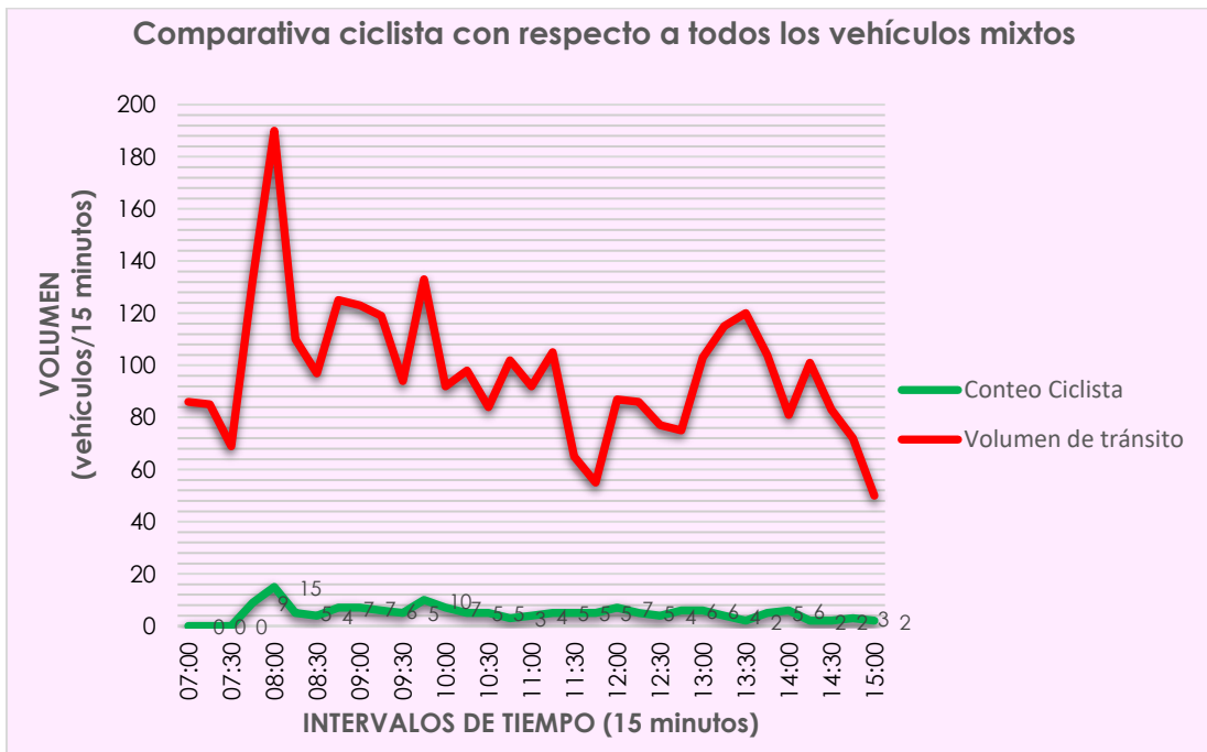
Gráfica No. 41. Comparativa del uso de la bicicleta respecto al volumen total.
