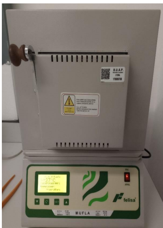
Figura 7: Mufla programada a una temperatura de 100°C durante 40 minutos para remover la humedad de la zeolita.
