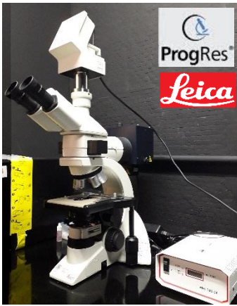
Figura 20. Características del microscopio de fluorescencia. En A el microscopio de fluorescencia DM 100 Led cuenta con un adaptador 1X que a su vez se acopla a la cámara ProgRes® C14 plus y el equipo utiliza como fuente de poder una lámpara de mercurio de alta intensidad. La selección de la longitud de onda se realiza con los filtros azul (DAPI; emisión a 460 nm), rojo (Rodamina-X-Red; emisión 590 nm) y verde (FITC; emisión 519 nm). A través del software Jenoptik Capture Pro se lleva a cabo la toma de fotomicrografías. Laboratorio de Neurofarmacología.
