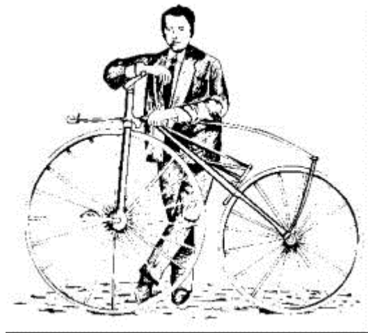
Figura 4 Draisiana con cigüeñal y bielas (citado por Pérez J., 1983)
