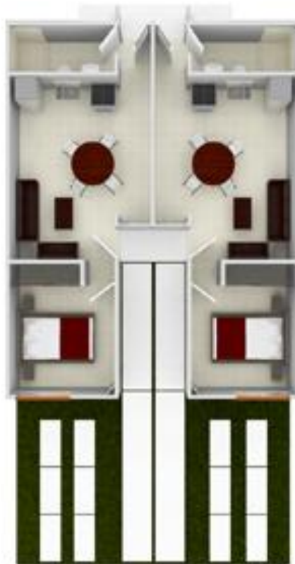
Imagen 53.- Planta Arquitectónica de vivienda del fraccionamiento “Prado Norte”, la cual solo contempla dos ventanas para ventilar la vivienda.
