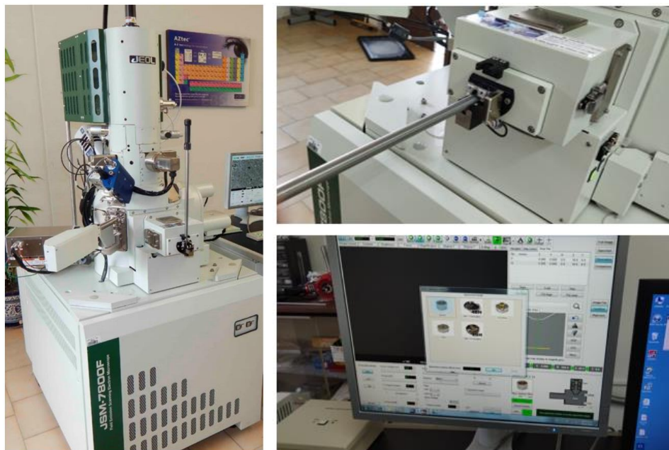
Fig. 2.7 Microscopio electrónico de barrido de emisión por campo ( JEOL modelo JSM-7800F)
