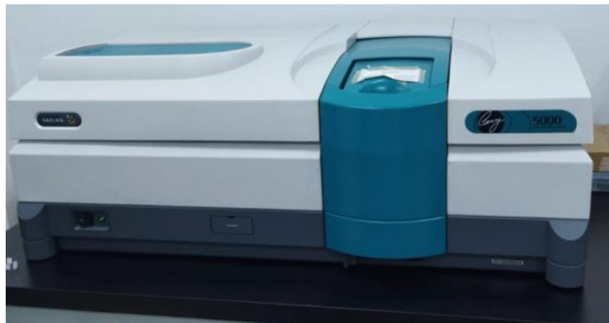
Fig. 2.16 Espectrómetro utilizado para la medición de los espectros de reflectancia difusa en las regiones UV-Vis-NIR.
