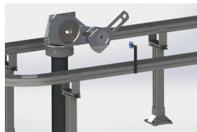
Figura 1.-Sistema banda transportadora-brazo robótico y cámara web.
