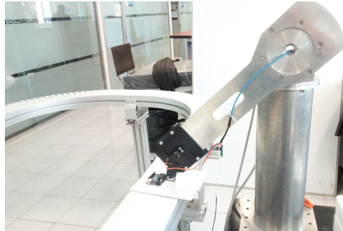
Figura 6.28: ROTRADI colocando tarjeta Arduino sobre la banda transportador.
