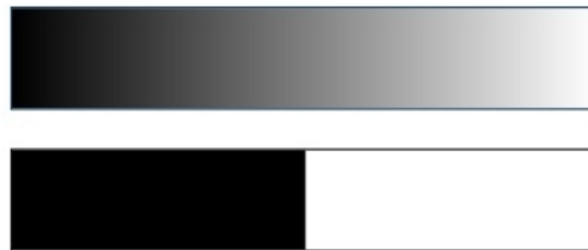
Figura 1.11: Obtención de una imagen binaria a partir de una imagen en escala de grises.
