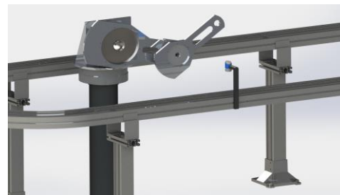
Figura 1.- Sistema banda transportadora-brazo robótico y cámara web.
