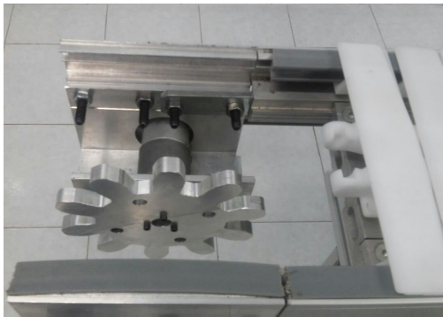
Figura 3.2: Soporte mecánico del motor.
