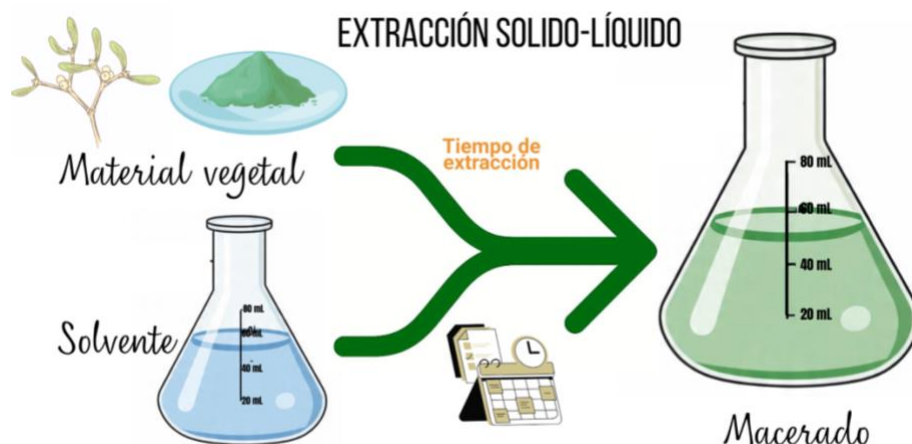
Figura 11. Esquema extracción por maceración (elaboración propia).
