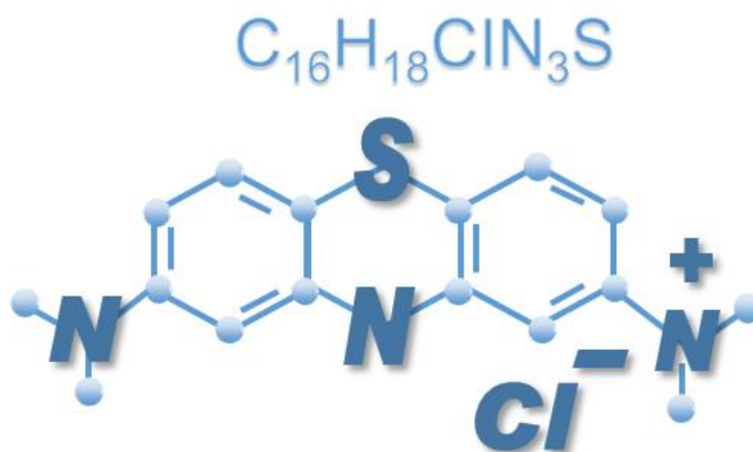
Figura 1.3. Estructura química del azul de metileno en la que se puede observar los anillos aromáticos que la conforman.
