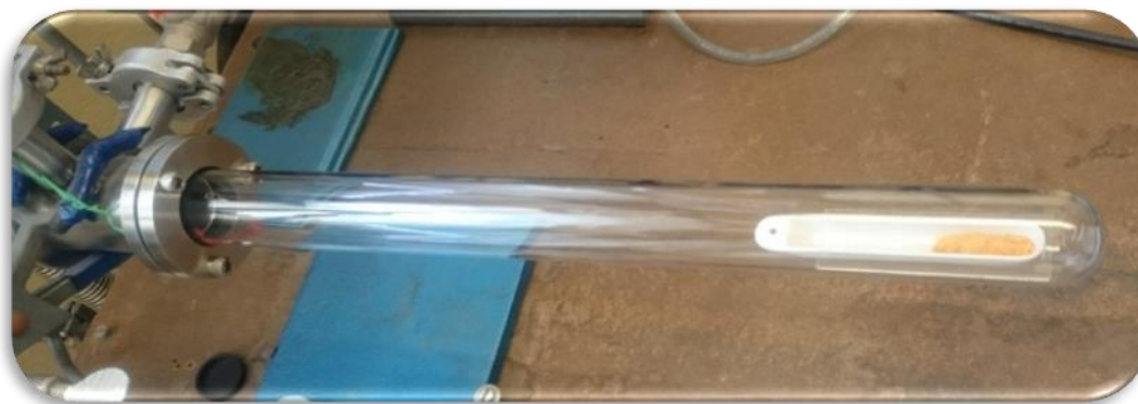
Figura 2.5. Tubo de cuarzo con muestra de SnS 2 .
