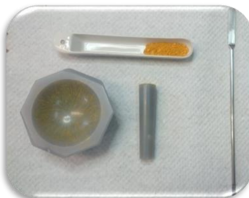
Figura 2.4. Muestra de fotocatalizador. antes de secado a 100 °C de SnS 2 .
