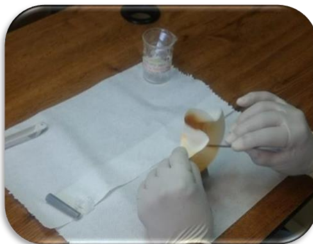
Figura 2.2 Separación del filtro de los polvos de \text{SnS}_2 después del secado a temperatura ambiente.
