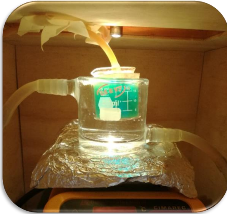
Figura 2.12. Dispositivo usado para la fotodegradación de azul de metileno.
