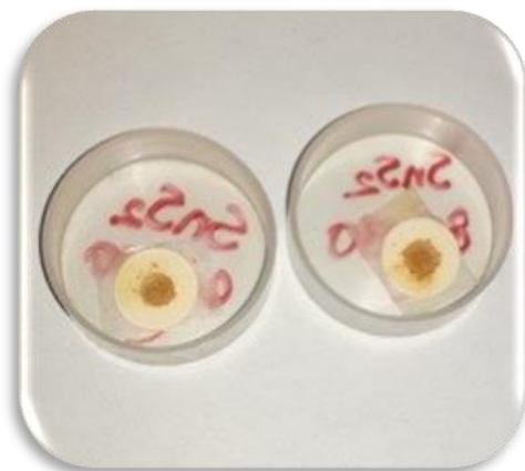
Figura 2.7. Insertos de las muestras de SnS 2 para la caracterización en infrarrojo lejano.
