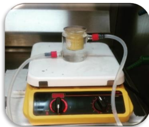
Figura 2.1 Dispositivo utilizado para la síntesis de SnS 2 en el que se muestra como la reacción química se desarrolló en un sistema cerrado.
