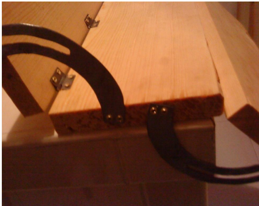
Vista lateral de asiento prototipo con dos planos abatibles
