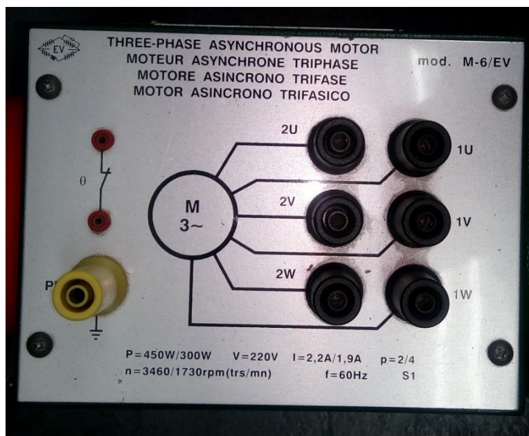
Figura 3. Datos de placa del motor Dahalander. (Equipo eléctrico de laboratorio)
