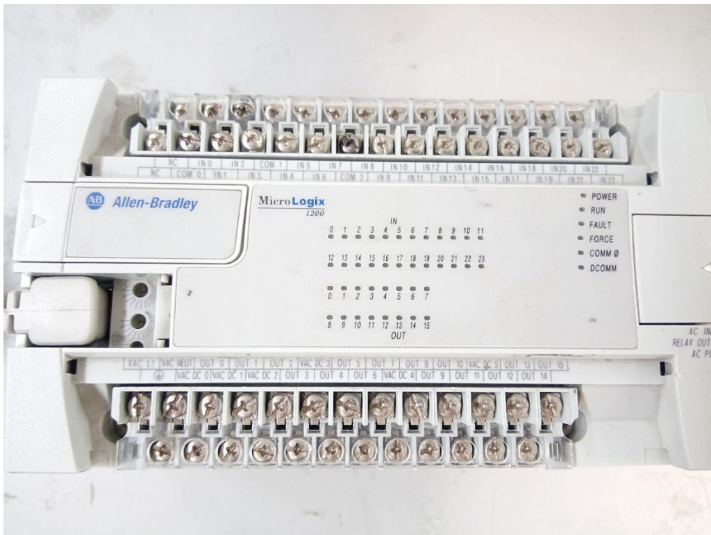
Figura 1.2. PLC MicroLogix 1200 que se utilizó en las prácticas. (Equipo eléctrico de laboratorio)
