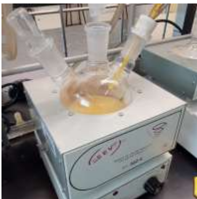
Figura 25. Síntesis del nanomaterial SiO 2 /resina-20-70.
