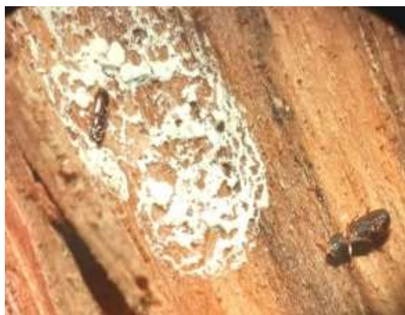
Figura 38. Descortezador en contacto con SiO 2 /resina-20-70 que logró penetrar a través de un orificio de entrada.
