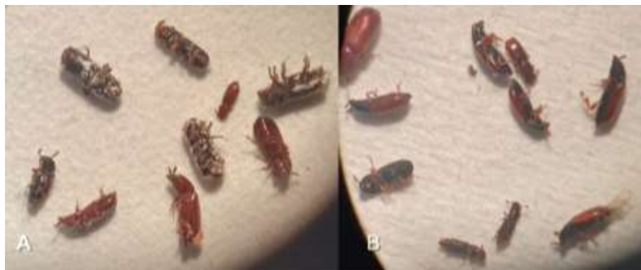
Figura 37. Descortezadores observados bajo el estereoscopio 36-A con mayor cantidad y 36-B con menor cantidad de SiO 2 /resina-20-70.
