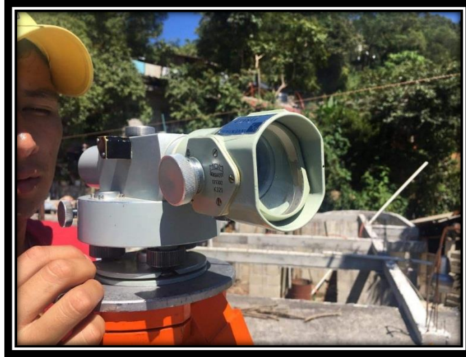
Fig. 10, nivel geodésico Zeiss ni2 con micrómetro de placa plano-paralela.
