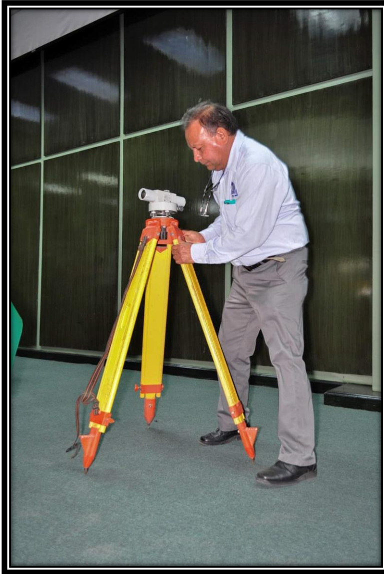
Fig. 17 Ingeniero Joel Panohaya Analco montando el nivel geodésico.
