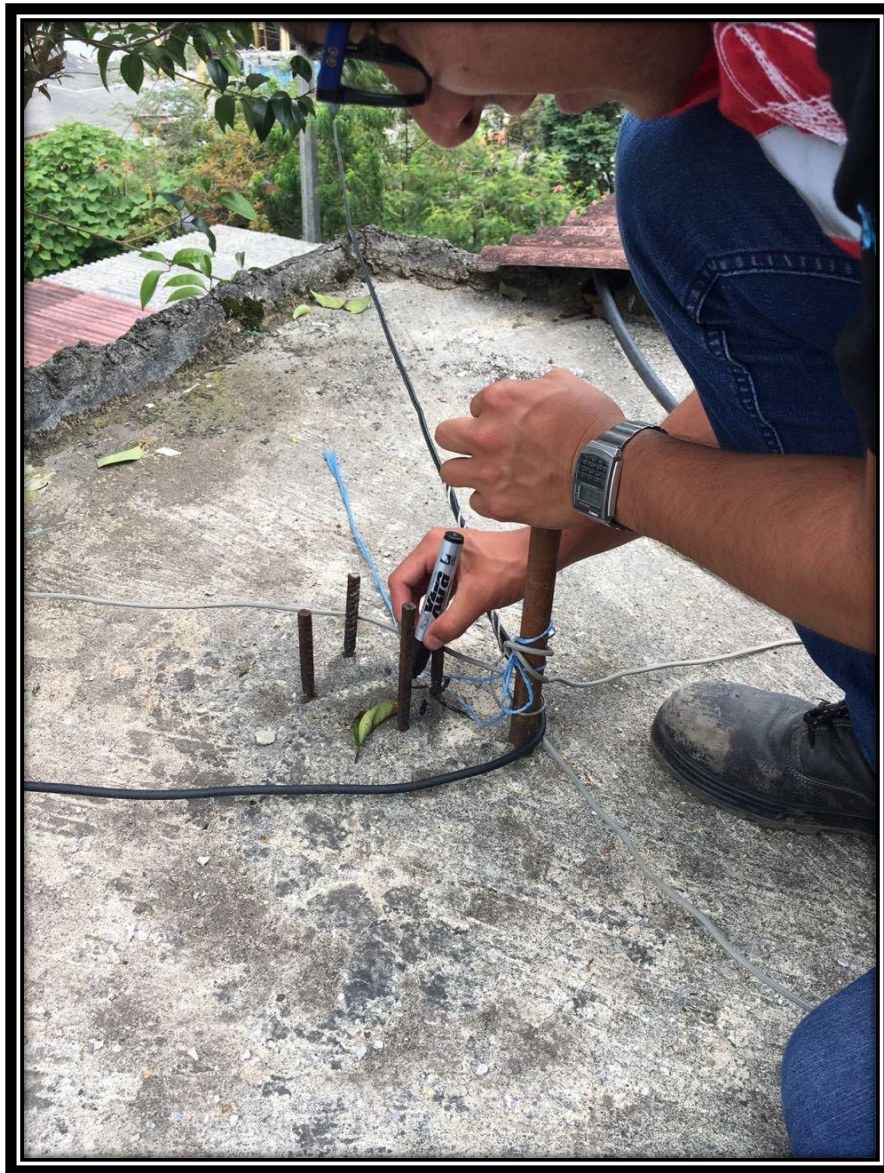
Fig. 26 Señalamiento de varilla para banco de nivel, Vértice X, Sitio Don Juan
