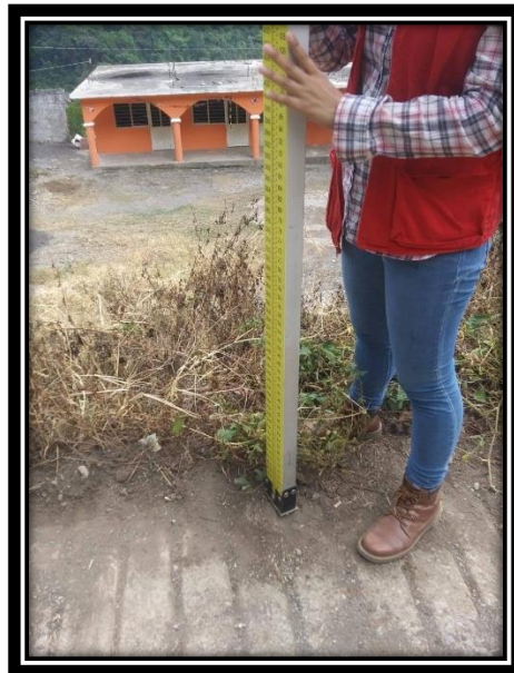
Fig. 11, mira de nivelación de material invar.
