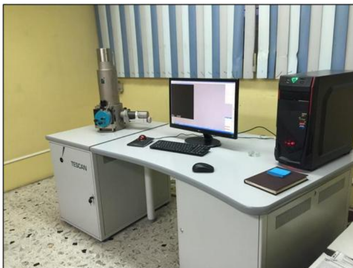
Figura 7. Microscopio Electrónico de Barrido (SEM) marca: Vega Tescan, modelo: TS5136SB.
