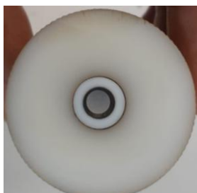
Figura 2. Soporte de Nylamid para probeta de acero API 5L X52.
