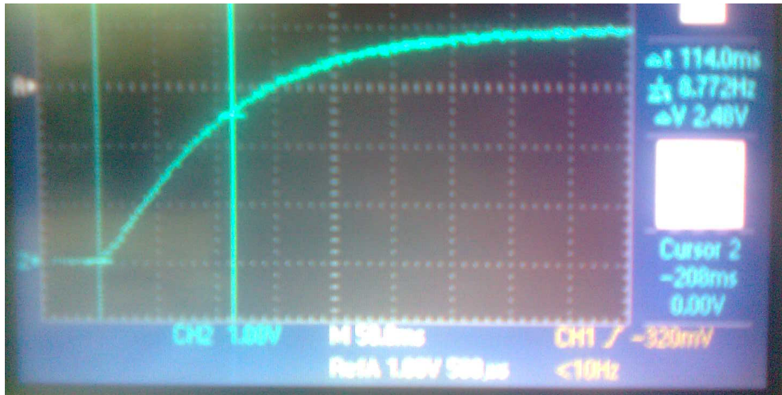
Figura 4.1: Vista en el osciloscopio de la respuesta de un motor de DC, al alimentarlo con 12v.
