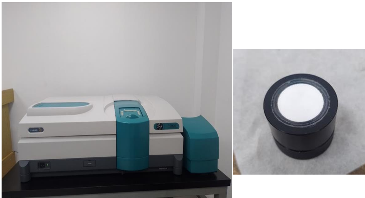
Figura 2.8 a) Espectrofotómetro de doble haz, marca Agilent modelo Cary 5000. b) referencia. Laboratorio Central del IFUAP-BUAP.
