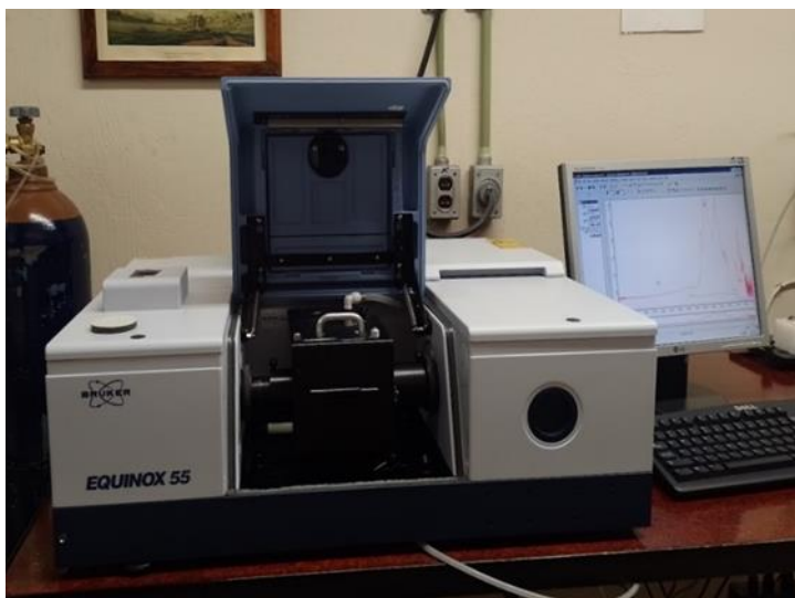
Figura 2.9 a) Espectrofotómetro Bruker Equinox 55 b) porta muestras. Laboratorio de Fotoluminiscencia del IFUAP-BUAP.
