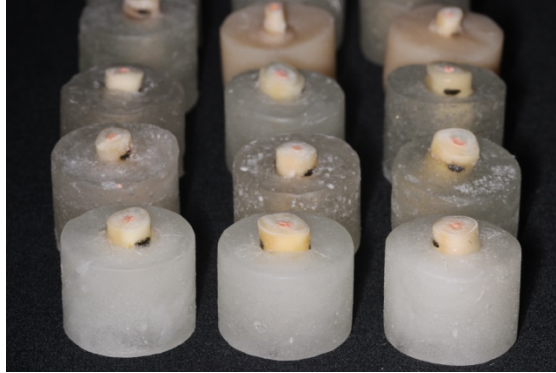
Figura 15. Órganos dentarios de bovino montados en acrílico transparente.
