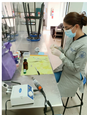
Figura 8 Corte de órganos dentarios de bovino. 19 mm con disco de diamante y micromotor.
