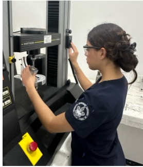
Figura 21. Manejo y colocación de adaptador y punta en la máquina Instron.
