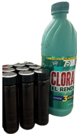
Figura 11. Alícuotas de NaOCl. Colocación de distintos volúmenes según el grupo al que corresponde, 40 ml, 50 ml, 60 ml y 100 ml. Frascos color ámbar.
