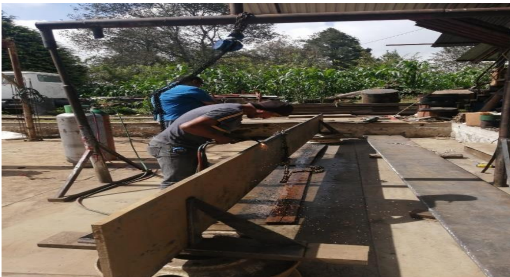
Figura XXI. Autoría propia. Biselado de placas con equipo de oxicorte.
