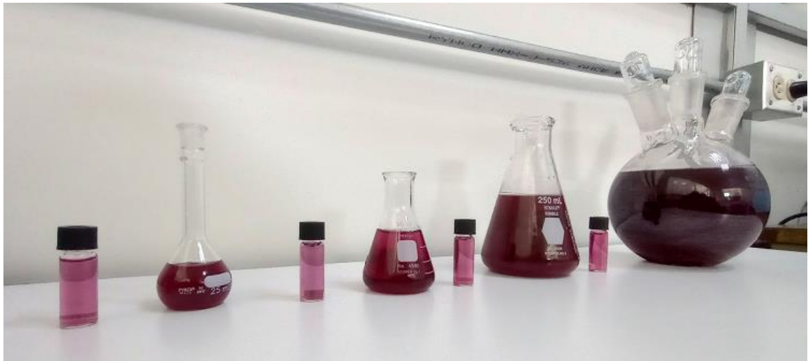
Figura 9. Síntesis de nanopartículas de Au a diferentes volúmenes a 45 °C.
