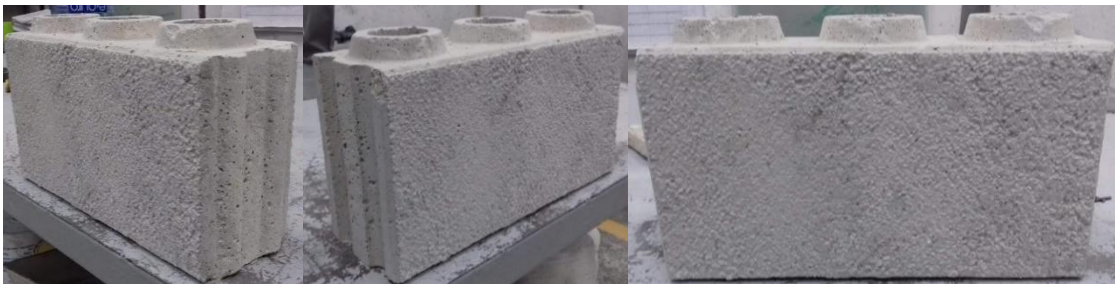
Figura 1.2 Block ensamblable de 3 machimbres. Reporte técnico para la obtención de las propiedades mecánicas del sistema QualytHome, 2019.
