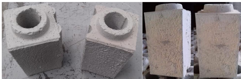
Figura 1.3 Block ensamblable de 1 machambre. Reporte técnico para la obtención de las propiedades mecánicas del sistema QualytHome, 2019.
