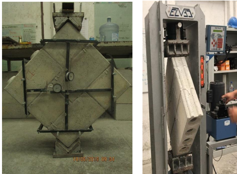
Figura 2.9 Instrumentación de muretes de la mampostería con micrómetros de caratula. Reporte técnico para la obtención de las propiedades mecánicas del sistema QualytHome,2019.
