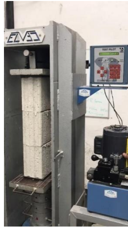
Figura 2.1 Prueba a compresión axial simple de una pieza de mampostería. Reporte técnico para la obtención de las propiedades mecánicas del sistema QuallytHome, 2019.
