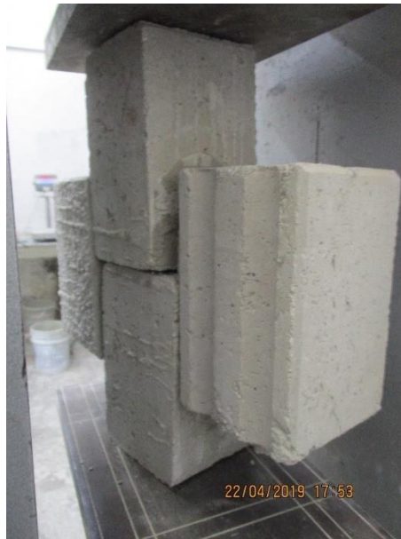
Figura 2.10 Espécimen para prueba de adherencia. Reporte técnico para la obtención de las propiedades mecánicas del sistema QualytHome,2019.
