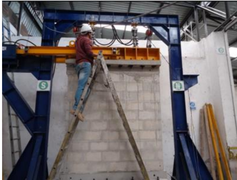
Figura 2.12 Ensayo de muro MM-07 a escala real y máquina de prueba. Comportamiento histerético de muros a escala real reforzados tipo QualytHome,2021.
