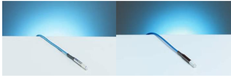
Figura 43. Ejemplos de detectores para campos pequeños. Izquierda: Detector de diodo. Derecha: Detector de diamante.
