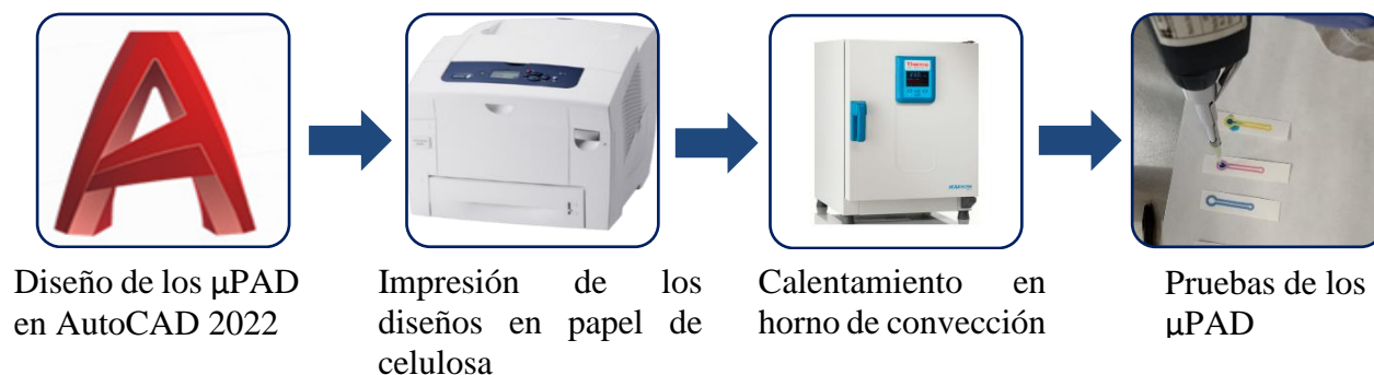
Figura 2.8. Diagrama experimental de la fabricación de los \mu PAD.
