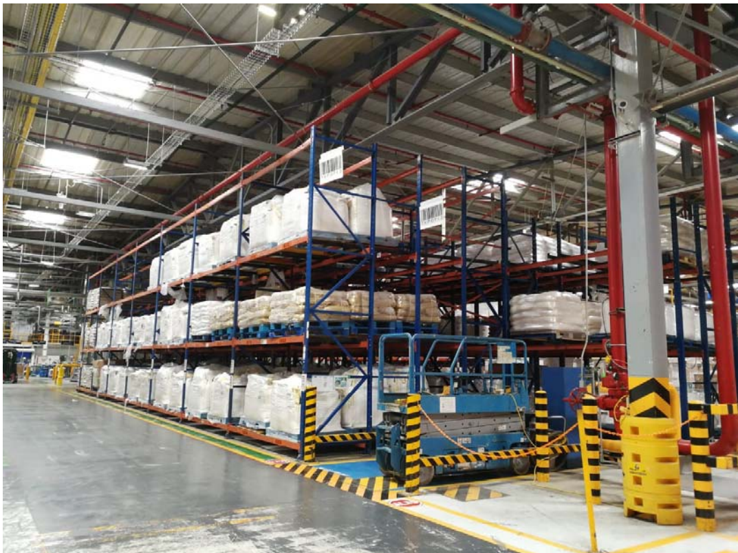
Figura 3. Carga habitual física de 550 kg/pallet con llenado parcial del rack
