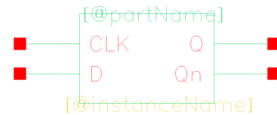
Figura 2.29: Símbolo de Flip-flop D en Virtuoso.
