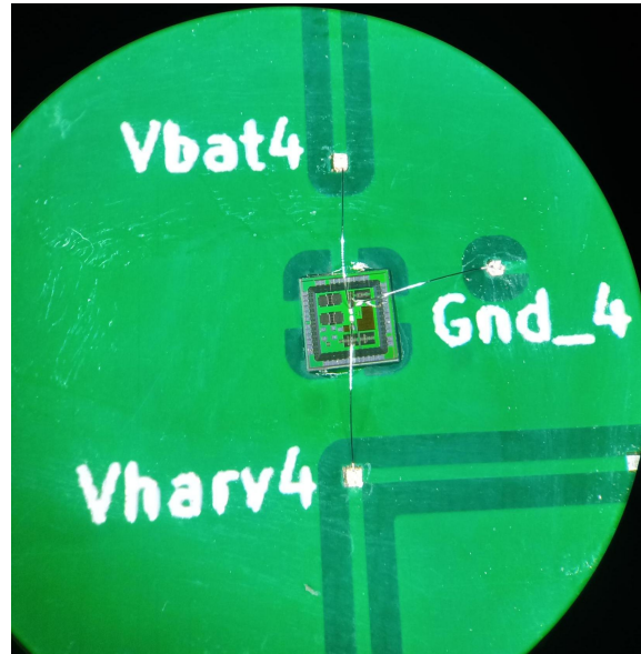
Figura 4.9: Wire Bonding Chip-PCB, Segunda Versión.
