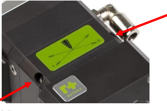
ILUSTRACIÓN 2.7 DIAGRAMA DE CENTRADO DEL LENTE (FUENTE: ALIEXPRES.COM)
