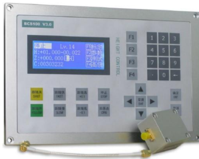
ILUSTRACIÓN 2.2 INTERFAZ CONTROLADORA DE ALTURA (FUENTE: HOLY-LASER.ES)
