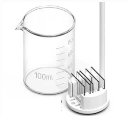
Figura 3.1: Vaso de precipitado y porta sustratos.
