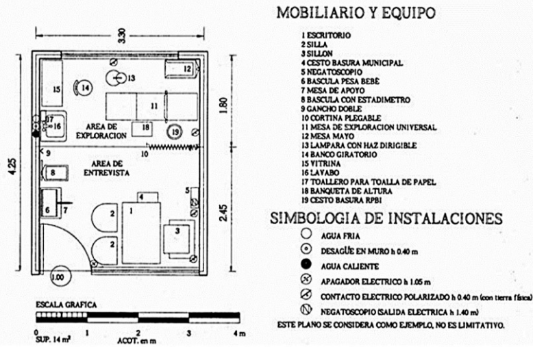
Figura 16: Consultorio Tipo I DE MEDICINA GENERAL .NOM-178-SSA1-1998 Que establece los requisitos mínimos de infraestructura y equipamiento de establecimientos para la atención médica de pacientes ambulatorios.
