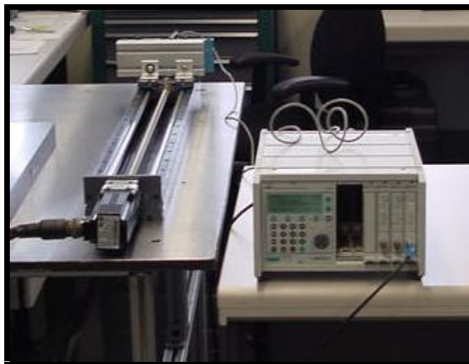
Figura 4.14 Sensor montado sobre la barra Thomson.
