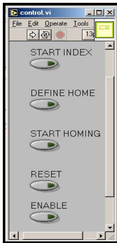
Figura 4.7 VI designado al control de movimiento.
