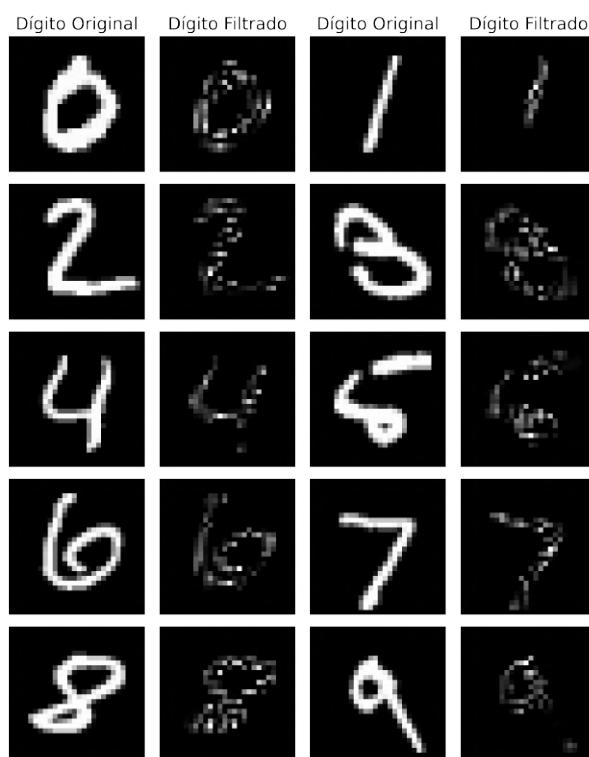
Figura 3.1: Resultados del filtro propuesto aplicados a imágenes de MNIST utilizando una RNC con una sola capa convolucional de 5 filtros de 2 \times 2 , seguida de un maxpooling de 2 \times 2 y una red densa de 100 unidades.
