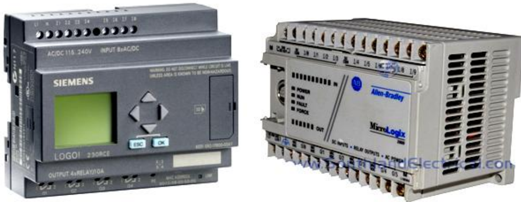
Figura 1.1. Aspecto de un PLC, SIEMENS izquierda (AutomatykaOnline), Allen Bradley derecha (Southland Electrical).
